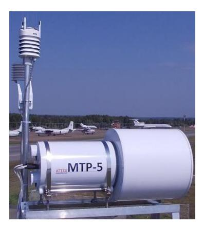
Прибор разработан для измерения профиля температуры до 1 км с представлением данных 10 метров, в диапазоне 0-100 м. Такое разрешение необходимо для работ в Полярных районах с мощными инверсиями в слое 100-200 метров и двойными инверсиями в диапазоне этих высот.
